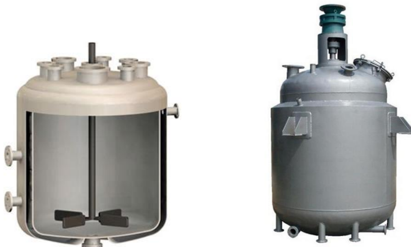
Gambar 11. Gambar Teknik tanki berpengaduk dan fabrikasinya sertifikat ASME
