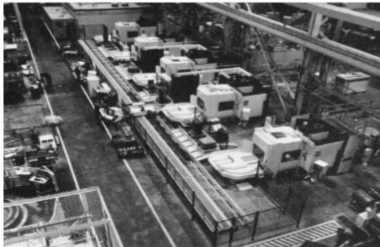
Gambar 12.12 Sebuah sistem manufaktur fleksibel lima stasiun. (Foto milik Cincinnati Milacron.)
