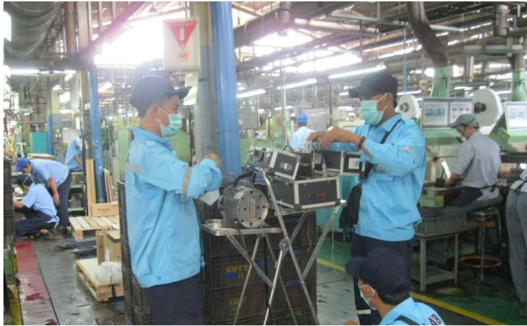
Gambar 46. Mengukur Iklim Kerja Tempat Kerja Menggunakan ISBB
