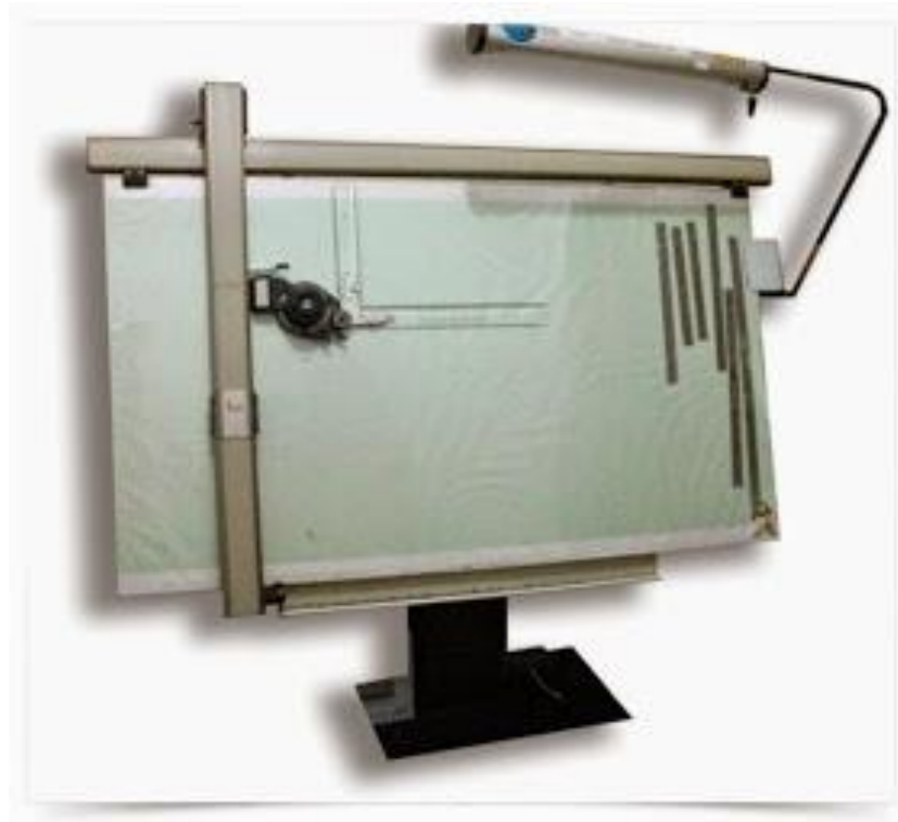
Gambar 7. Alas untuk menggambar Teknik, Meja Gambar.
