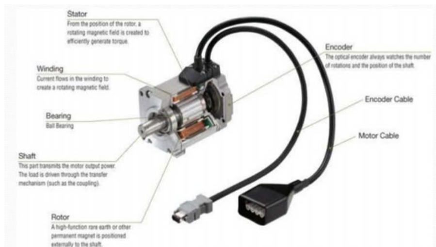
Gambar 3.7 : komponen motor servo [2]
