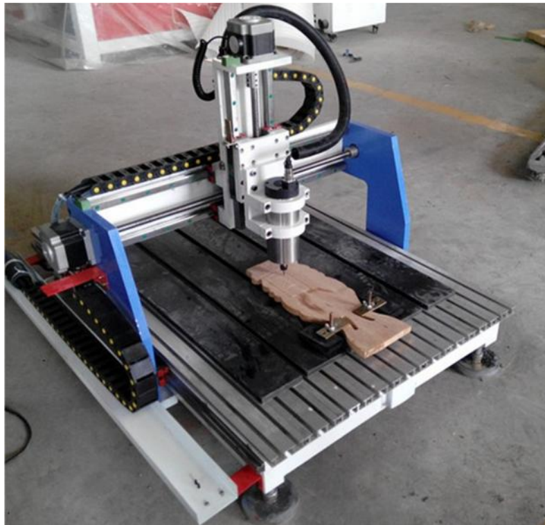
Gambar 2.1 ; mesin router kayu berbasis CNC [2]
