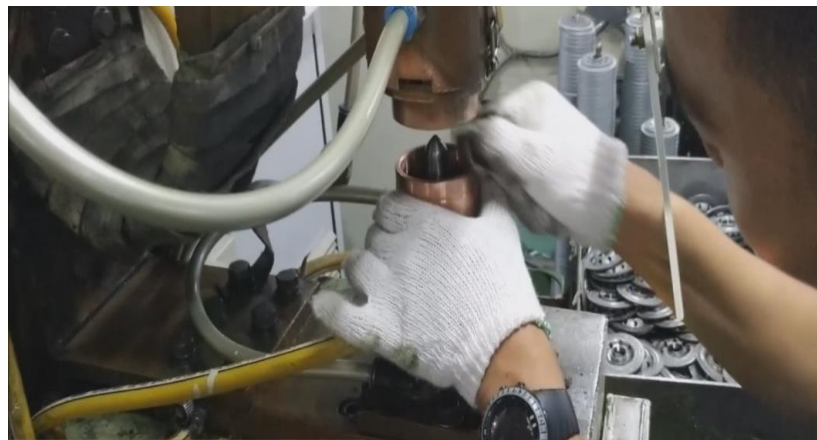
Gambar 4.5 Proses Pengamplasan Elektroda
