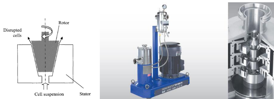
Gambar 9.21. Pemecahan sel menggunakan rotor-stator mill
