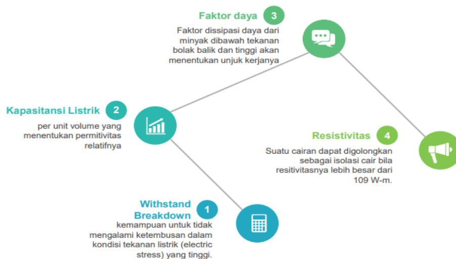
Gambar 3.1 Cara Kerja Cairan Isolasi
