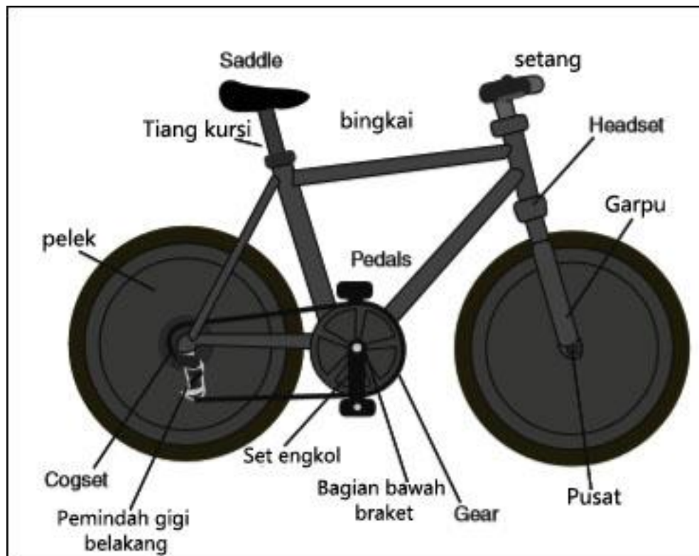
Gambar 12.3 Komponen utama sepeda
